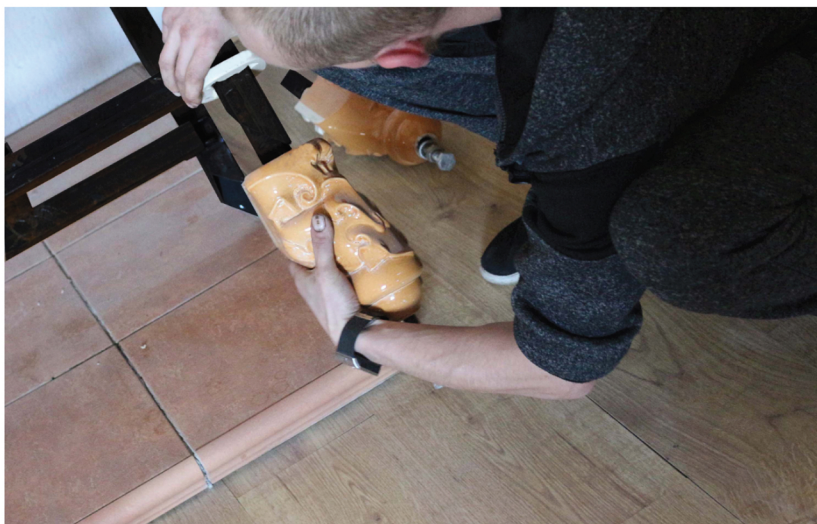
3.Одеваем ногу и шайбу наклонив каркас
